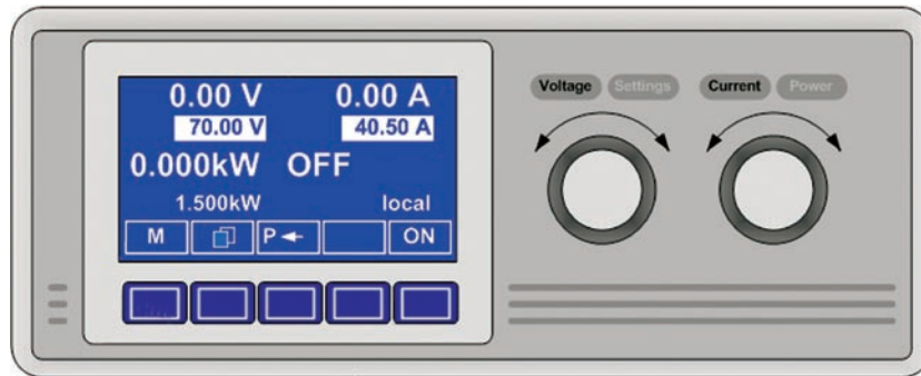
Drehgeber für Einstellungen Rotary encoder for settings
